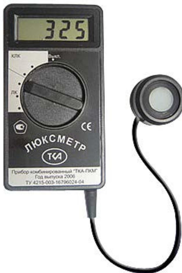
Рисунок 14 – Внешний вид люксметра ТКА-ЛЮКС
