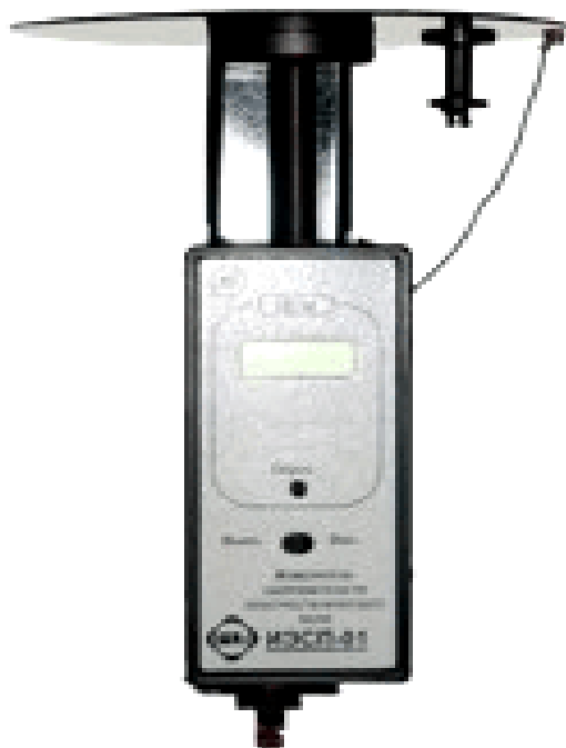
Рисунок 6 – Внешний вид измерителя электростатического поля ИЭСП-01
