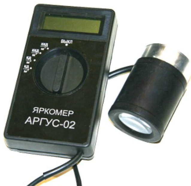
Рисунок 16 – Внешний вид фотометра-яркомера «Аргус-02»
