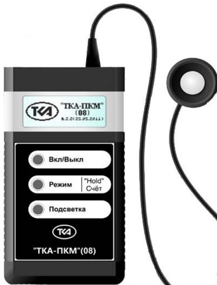
Рисунок 15 – Внешний вид Пульсметра+Люксметра «ТКА-ПКМ» /08
