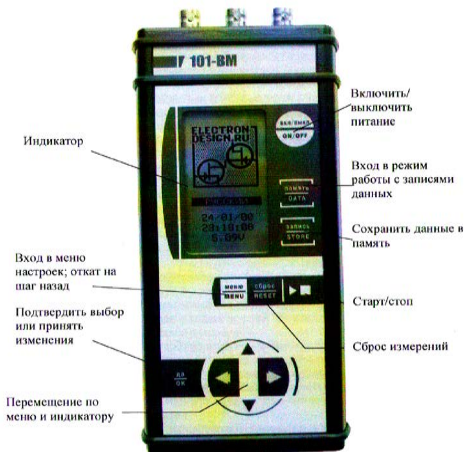
Рисунок 2 – Внешний вид прибора Октава-110В/101ВМ и описание клавиш
