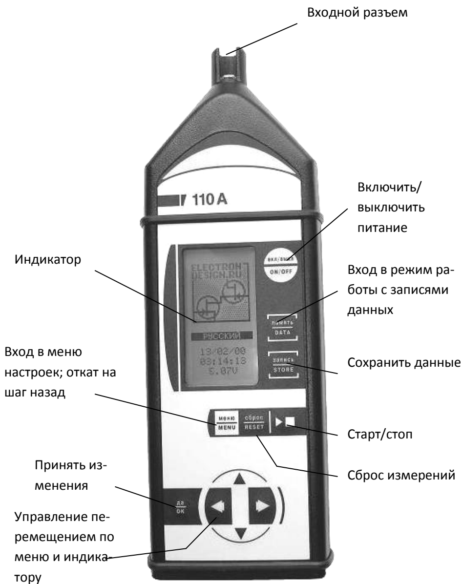
Рисунок 1 – Внешний вид шумомера Октава-110А и описание клавиш
