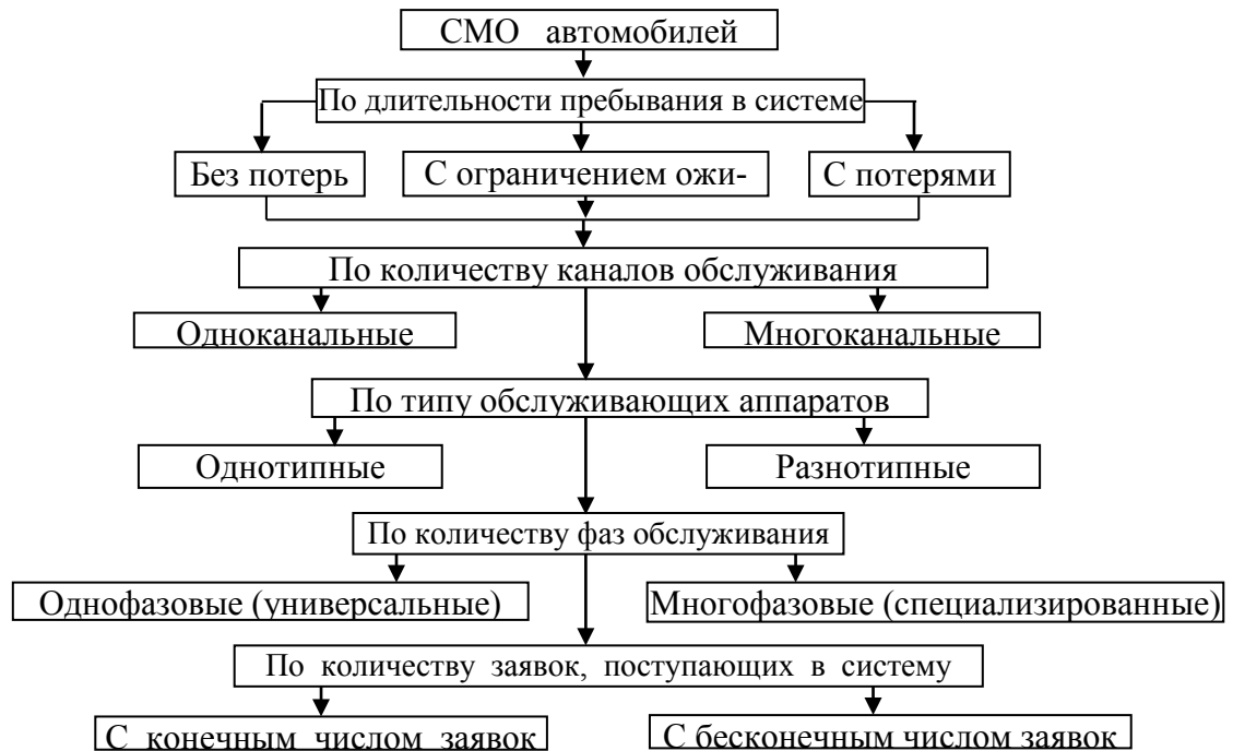
Рисунок 1.2 – Классификация СМО автомобилей
