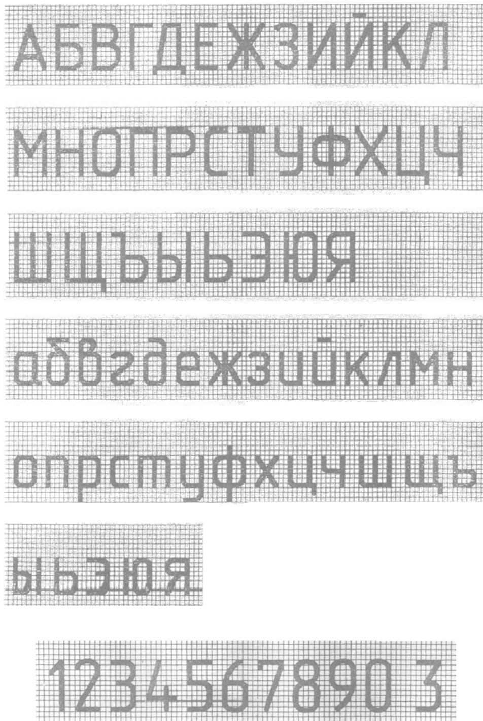
Рисунок Б1 – Шрифт типа Б без наклона
