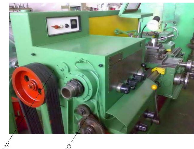
Рисунок 2 а – Токарно-винторезный станок I6K20 (вид на гитару сменных колес)
