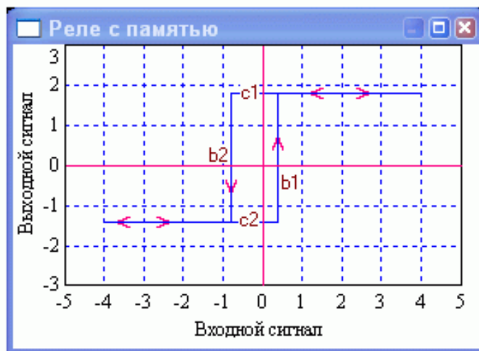
Рисунок 15 - Содержание составного блока "Реле с памятью".
