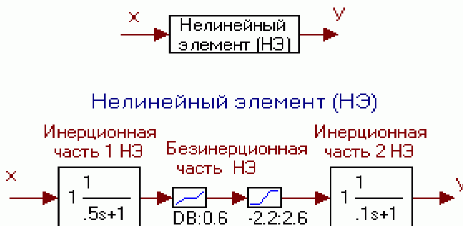
Рисунок 6 - Пример Л-БН-Л-модели нелинейного элемента
