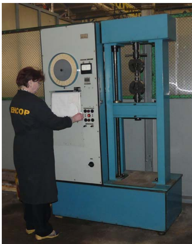
Рис.5. Общий вид (а) и кинематическая схема разрывной машины Р-5 (б): 1 - электродвигатель; 2 - силовой редуктор; 3 - цилиндрические шестерни; 4 - вращающиеся винты; 5 - гайки подвижной траверсы; 6 - подвижная траверса; 7 - неподвижная траверса; 8 - поводок; 9 - рейка; 10 - шестерня реечной передачи; 11 - шкив; 12 - тросик; 13 - перо; 14 - барабан лентопротяжного механизма; 15 - редуктор масштаба записи; 16 - валик.
