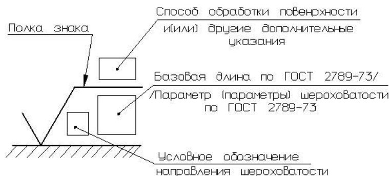
Рисунок 12 – Структура знака шероховатости
