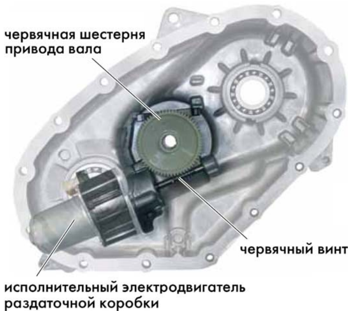
Рисунок 2.7 – Привод переключающего вала
