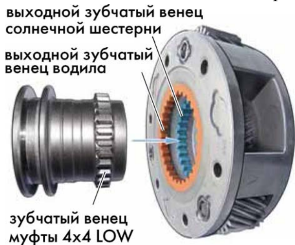
Рисунок 2.5 – Зубья муфты включения, водила и солнечной шестерни
