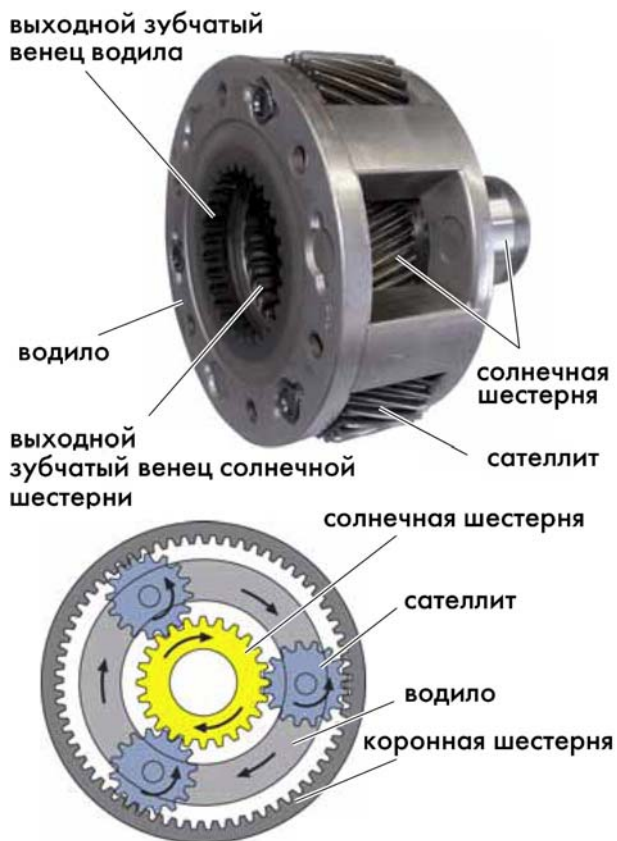
Рисунок 2.3 – Планетарная передача
