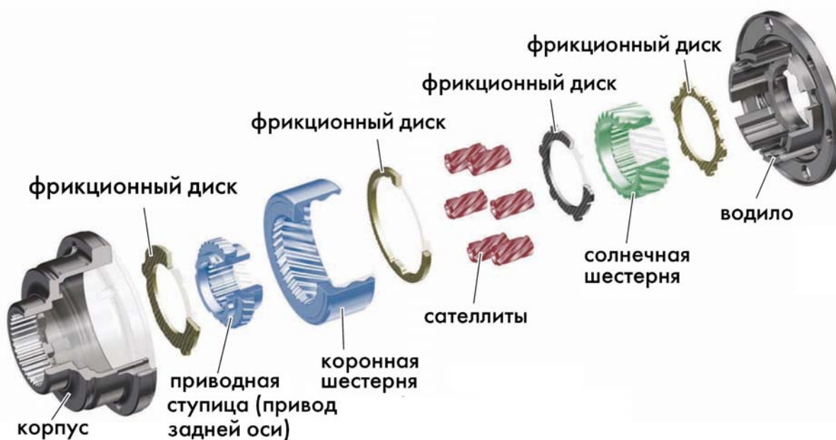
Рисунок 2.10 – Составные части самоблокирующегося дифференциала
