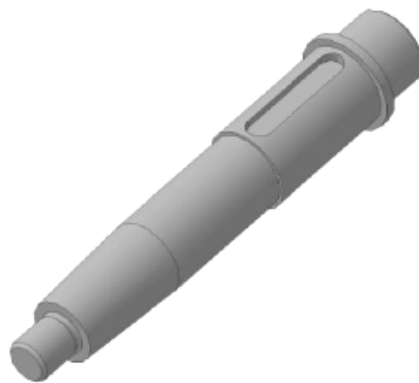
Рисунок 2.1 – Приводной вал редуктора
