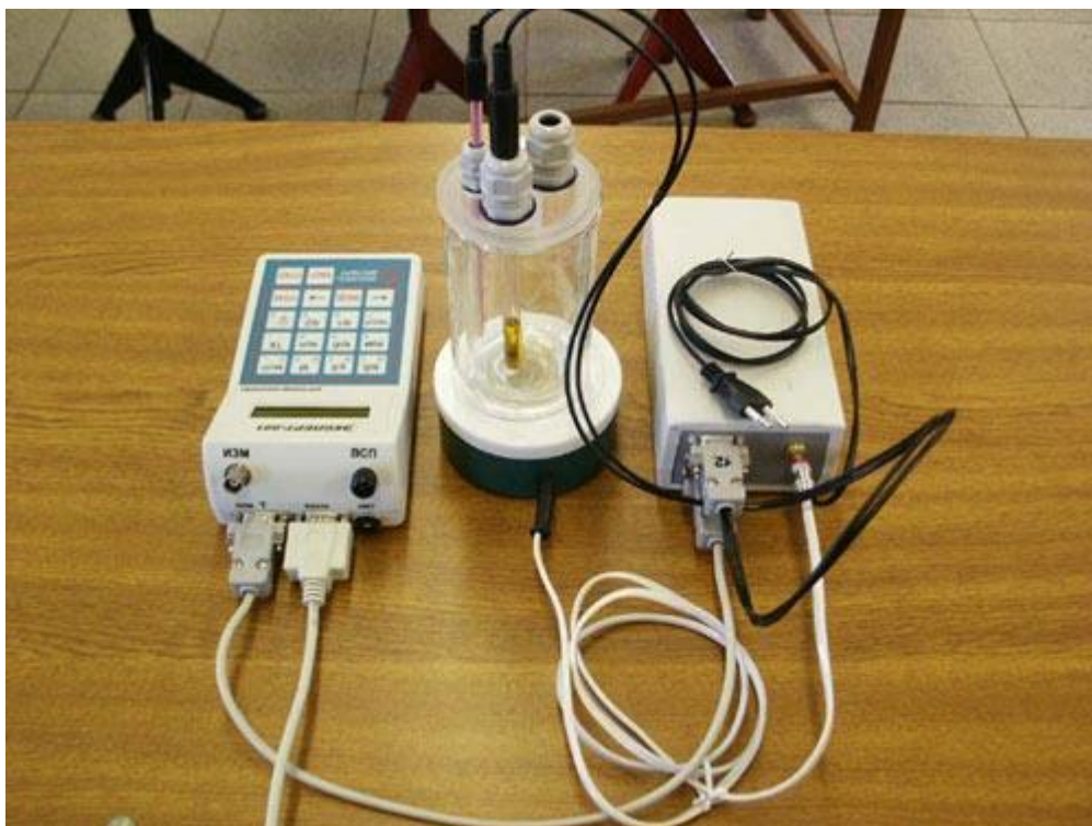
Рис.5. Калориметрическая установка. Вид сзади. Схема подключения кабелей
