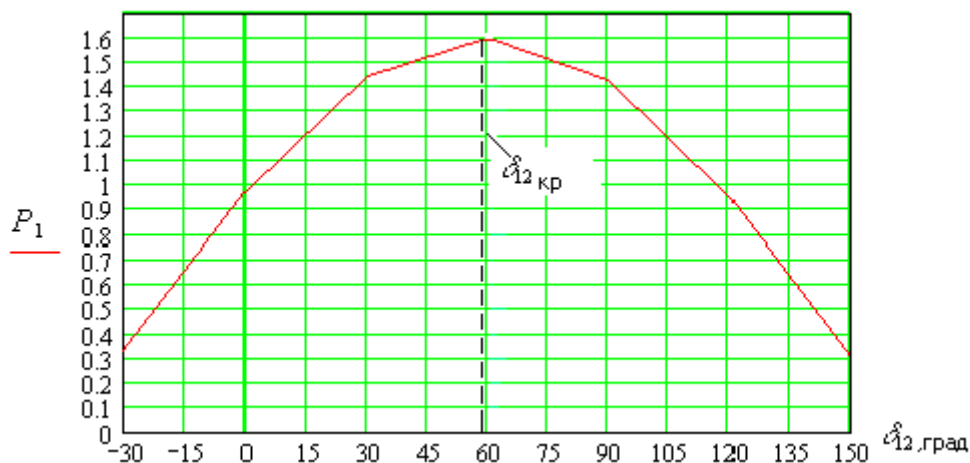
Рис.1-7. Угловая характеристика мощности генератора
