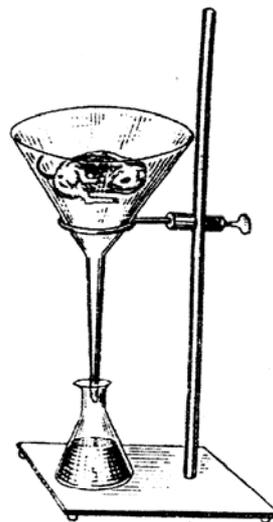
Рис. 7. Приспособление для сбора эктопаразитов с мелких животных
