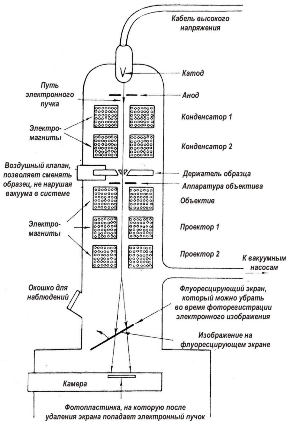
Схема электронного микроскопа (по Хиггису, Мухи, Мюру, Роберту, Уокеру, 1967)
