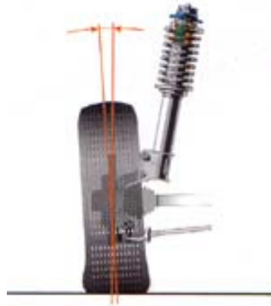
Рисунок 5.2 – Угол между плоскостью вращения колеса и вертикалью (развал)
