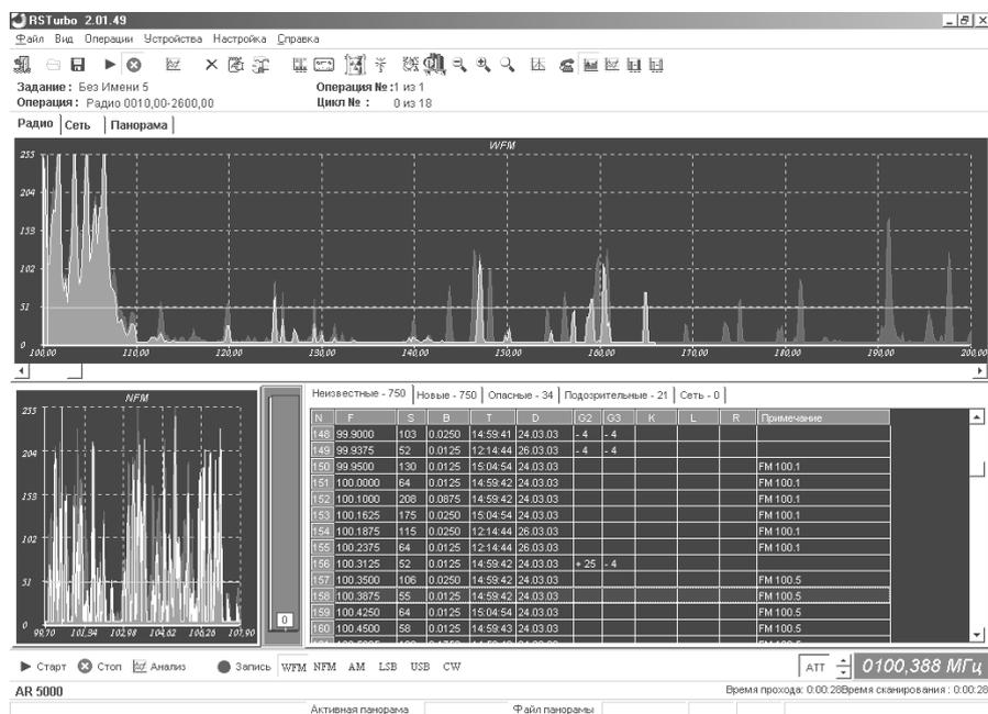
Рисунок 3 - Окно панорамного отображения спектров
