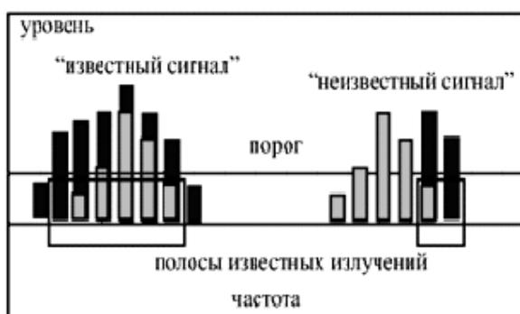
Рисунок 4 - Классификация сигналов на «известные» и «неизвестные»
