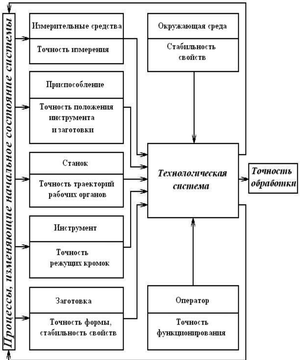
Рис. 5. Схема компонентов технологической системы и их влияние на точность обработки
