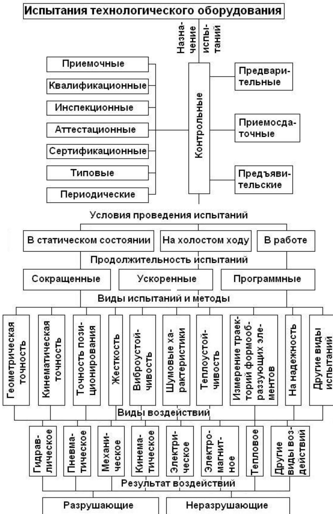
Рис. 4. Обобщенная схема испытаний технологического оборудования
