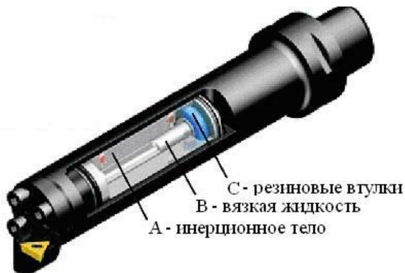
Рис. 13. Антивибрационная оправка со встроенным демпфером, настроенным на подавление колебаний с частотой, обусловленной определенным вылетом
