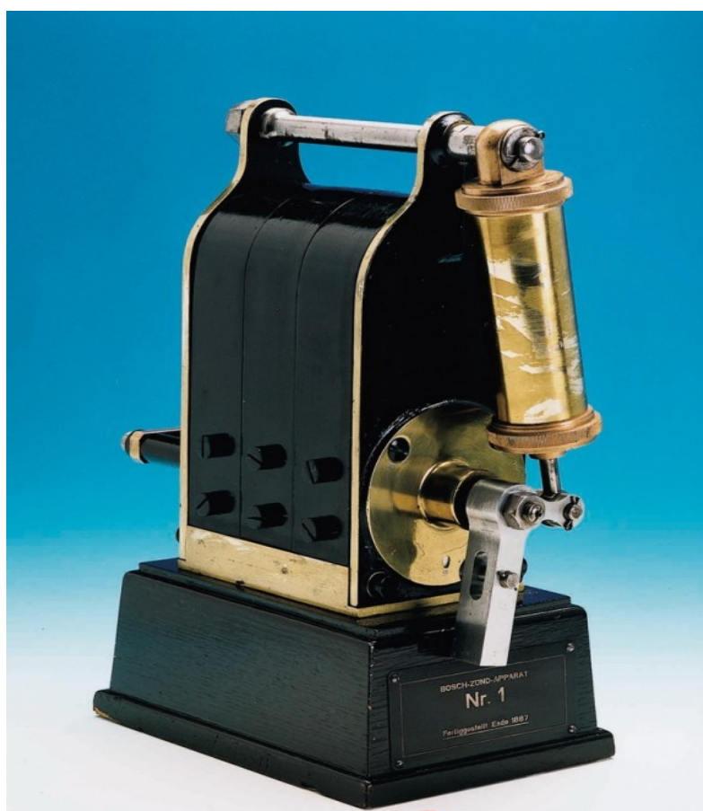
Рисунок 7 – Первые магнето BOSCH для стационарных ДВС
