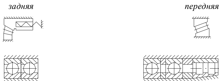
Рисунок 1 - Конструктивная схема шпинделя и варианты передней и задней опор
