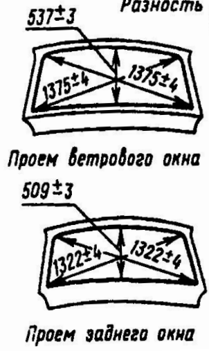
Рисунок А1- Линейные размеры проемов кузовов автомобилей ВА3
