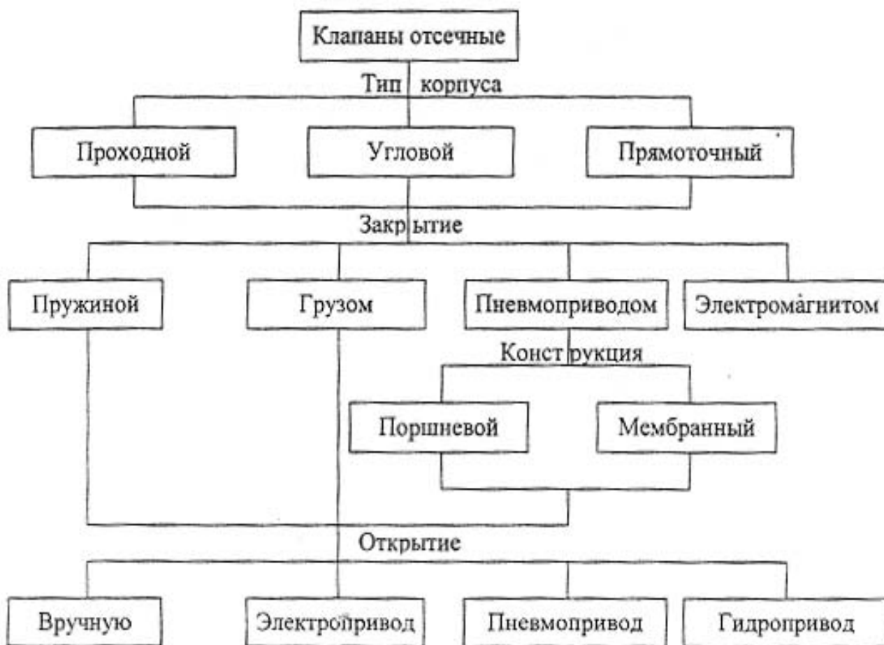
Рис. 32. Классификация отсечных клапанов
