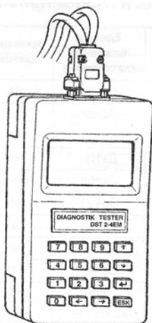
**Рис. 25** Диагностический прибор DST-2
